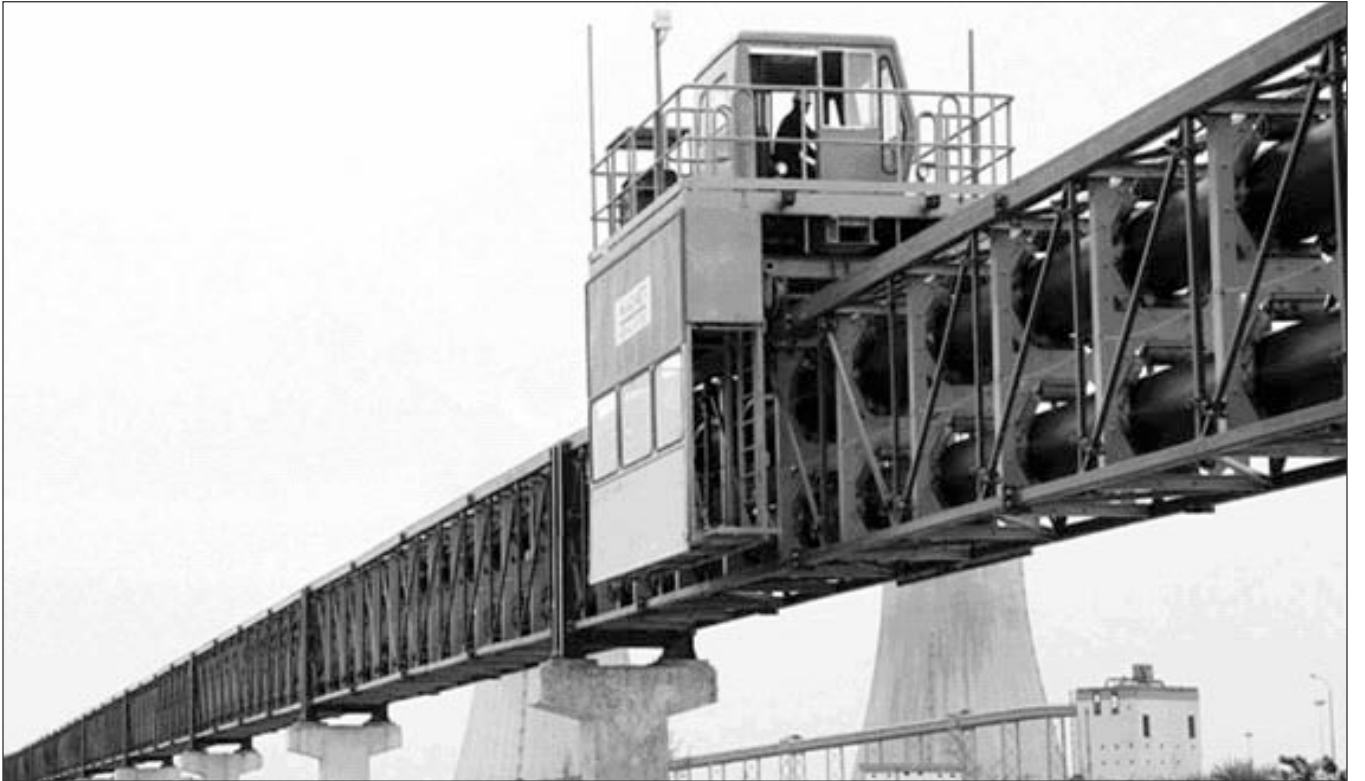
कोराडी, खापरखेडा व चंद्रपूर औष्णिक विद्युत केंद्रासाठी कोळसा वाहतुकीकरीता पाईपवाहक यंत्रणेची नवीन संकल्पना
